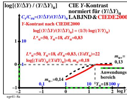
TUB-Prüfvorlage egr4; Vergleich der LABJND- und der CIEDE2000-Farbabstandsformel
