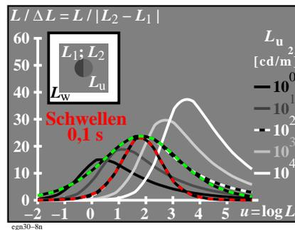
**Doppel-Linienelement von Richter (1987) für die Lichttechnik mit der Leuchtdichte  $L = f(L_P, M_D, S_T)$**
