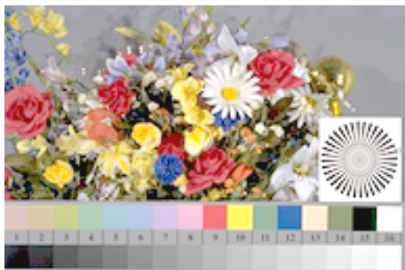
ecc60-1n, ecb60-7a, ANC40-6N; sf: +0,5 stop, 192 x 128 pixel, gamma = 0,47
