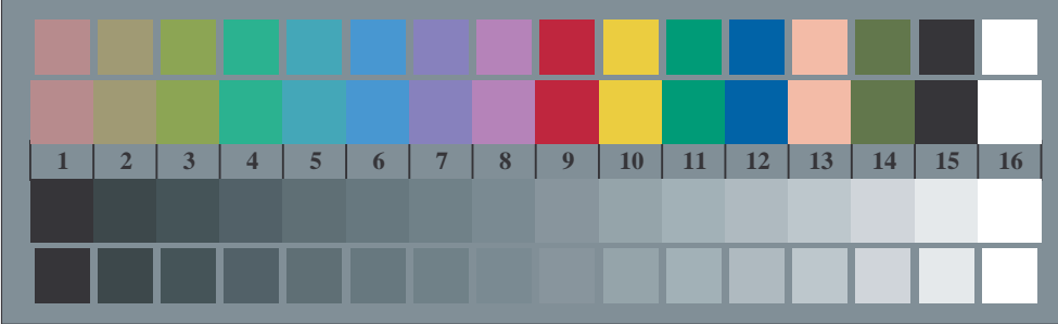
TS970-7, Fig. B3Wdd: CIE 14 colores del test y 2 + 16 pasos de gris (sf); PS operator: rgb/cmy0 \rightarrow rgb_{dd} setrgbcolor
