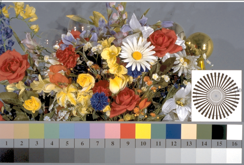
TS930-3, Fig. B1W-: motivos florales, CIE 14 colores del test y 2 + 16 pasos de gris (sf); PS operator 4 colorimage
