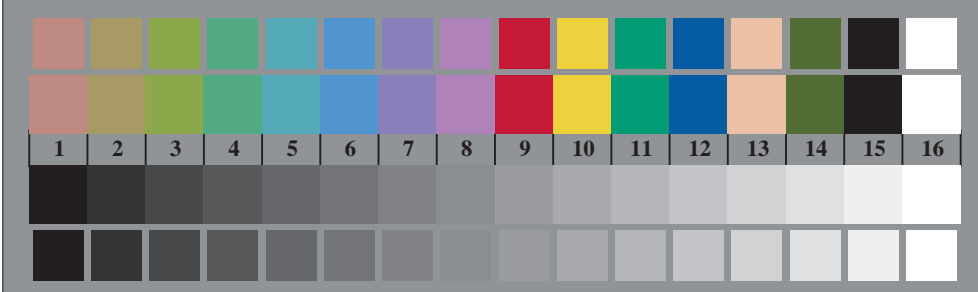
TS840-7, Fig. D3Wd: CIE 14 colores del test y 2 + 16 pasos de gris (sf); rgb/cmy0 \rightarrow rgb_d setrgbcolor
