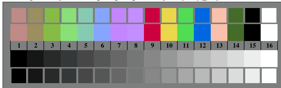
TS810-7, Fig. D3Wdd: CIE 14 colores del test y 2 + 16 pasos de gris (sf); rgb/cmy0 \rightarrow rgb_{dd} setrgbcolor
