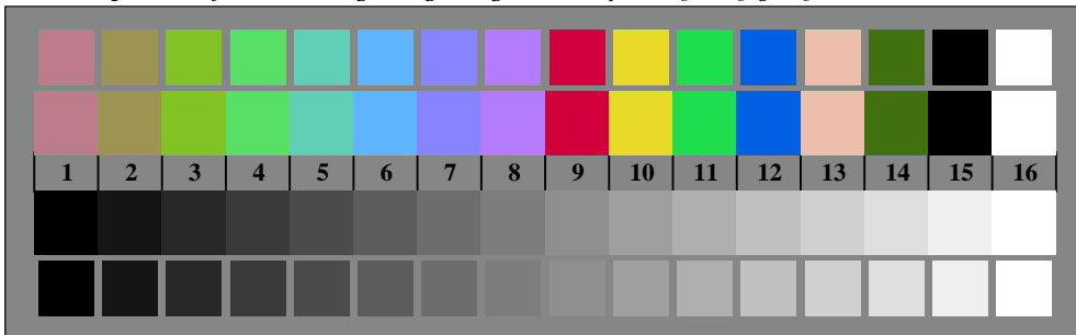
TS810-7, Fig. D3Wd: CIE 14 colores del test y 2 + 16 pasos de gris (sf); rgb/cmy0 \rightarrow rgb_d setrgbcolor
