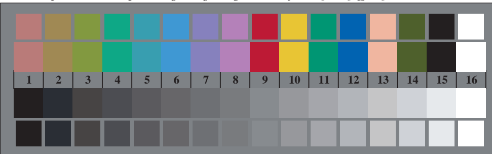
TN840-7, Figur D3Wdd: 14 CIE-prøvefarger og 2 + 16 gråtrinn (sf); rgb/cmy0 \rightarrow rgb_{dd} setrgbcolor
