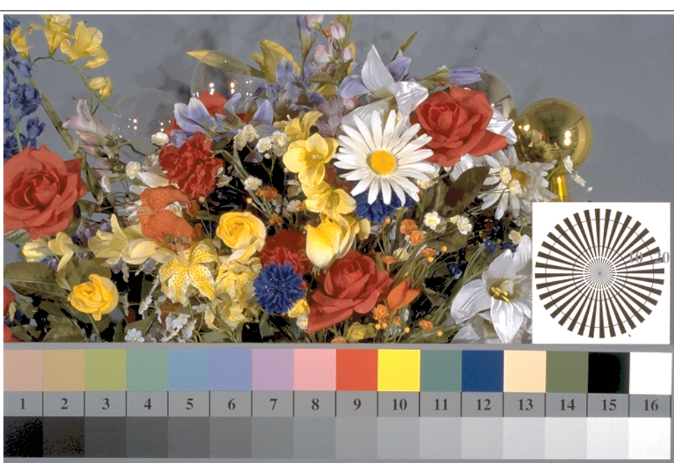
TI940-3, Fig. B1Wd: motivo floreale, 14 prova colori CIE i 2 + 16 grigio passi (sf); ; PS operator 4 colorimage
