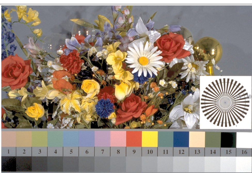
TI930-3, Fig. B1Wdd: motivo floreale, 14 prova colori CIE i 2 + 16 grigio passi (sf); ; PS operator 4 colorimage
