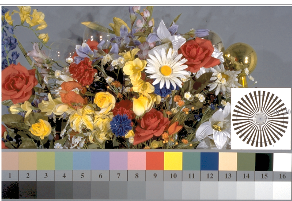
TI880-3, Fig. D1Wde: motivo floreale, 14 prova colori CIE i 2 + 16 grigio passi (sf); : PS 4 colorimage
