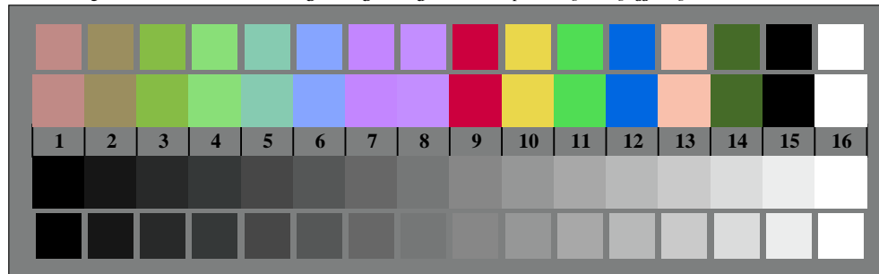
TI810-7, Fig. D3Wdd: 14 prova colori CIE i 2 + 16 grigio passi (sf); rgb/cmy0 \rightarrow rgb_{dd} setrgbcolor
