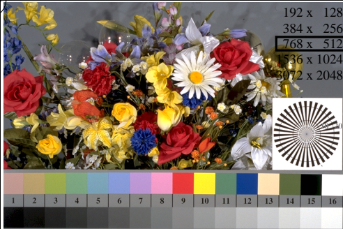
T1800-3, Fig. D1W--: motivo floreale, 14 prova colori CIE 1+2 + 16 grigio passi (sf); ; PS operator 3 colorimage
