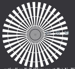
reticoli radiali (Siemens stelle) N-W
