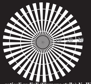
reticoli radiali (Siemens stelle) N-W
