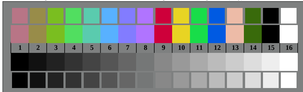
Bild D3: 14 CIE-Prüffarben sowie 2 + 16 Graustufen (sf); PS-Operator olv* setrgbcolor (only)
