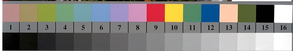
Bild D1: Blumenmotiv, 14 CIE-Prüffarben sowie 2 + 16 Graustufen (nf); PS-Operatoren settransfer, 3 colorimage
