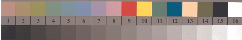
Bild D1: Blumenmotiv, 14 CIE-Prüffarben sowie 2 + 16 Graustufen (nf); PS-Operatoren settransfer , 4 colorimage
