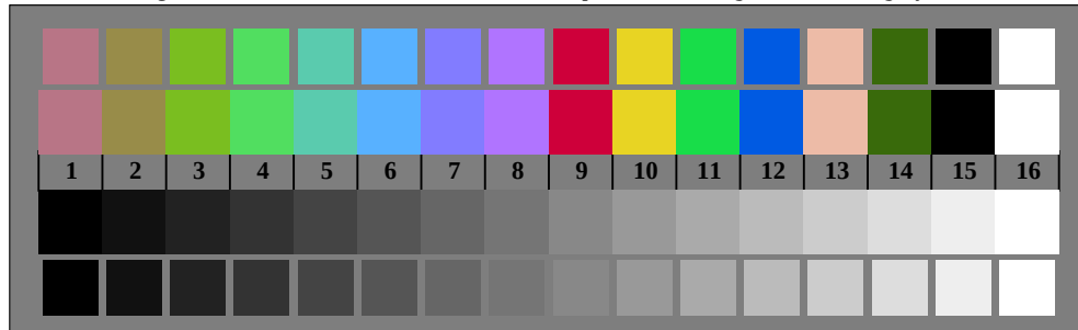
Bild B3: 14 CIE-Prüffarben sowie 2 + 16 Graustufen (sf); PS-Operator olv* setrgbcolor / w* setgray
