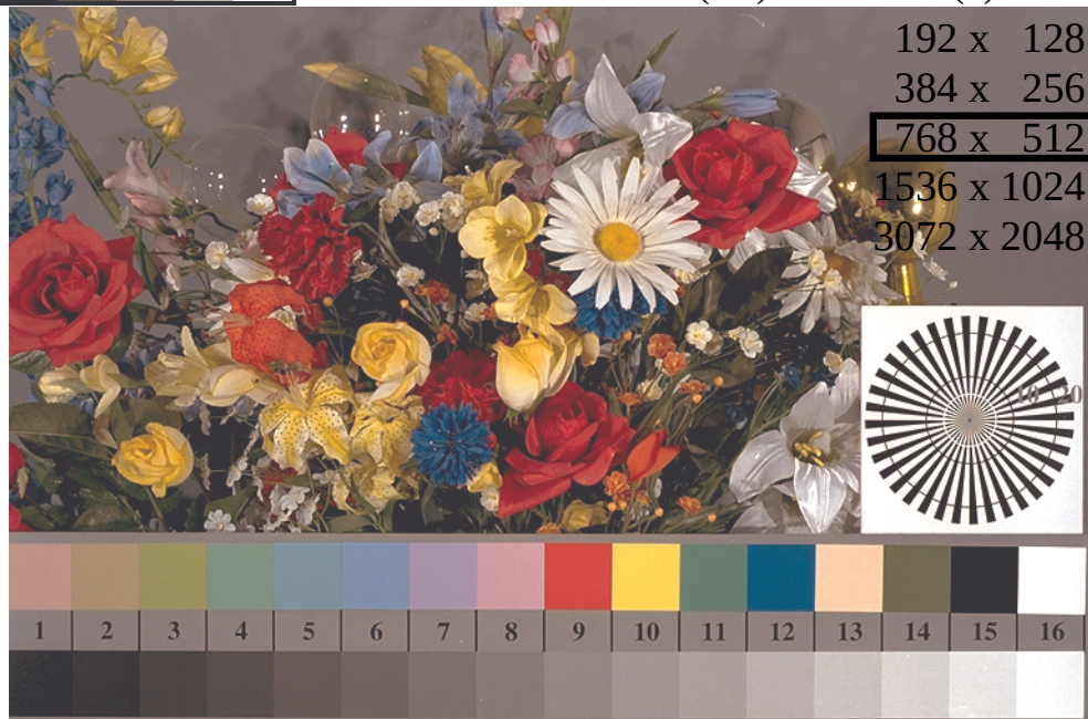
Fig. D1: Motif fleuri, 14 CIE test couleurs et 2 + 16 paliers de gris (nf); PS opérateurs settransfer , 4 colorimage
