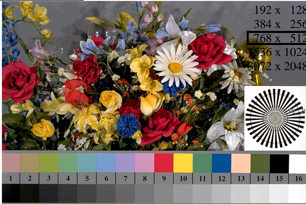
Fig. D1: Motif fleuri, 14 CIE test couleurs et 2 + 16 paliers de gris (nf); PS opérateurs settransfer , 3 colorimage
