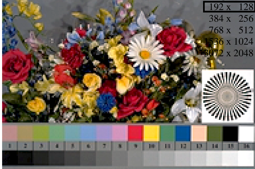
DFD60-3N, Fig. D1: Motif de fleurs, 14 couleurs test CIE et 16 marches de gris (nf); PS operators settransfer , 3 colorimage
