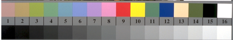
AGE61-3N, Bild B1: Blumenmotiv, 14 CIE-Prüffarben und 16 Graustufen (sf); PS-Operatoren settransfer , 3 colorimage
