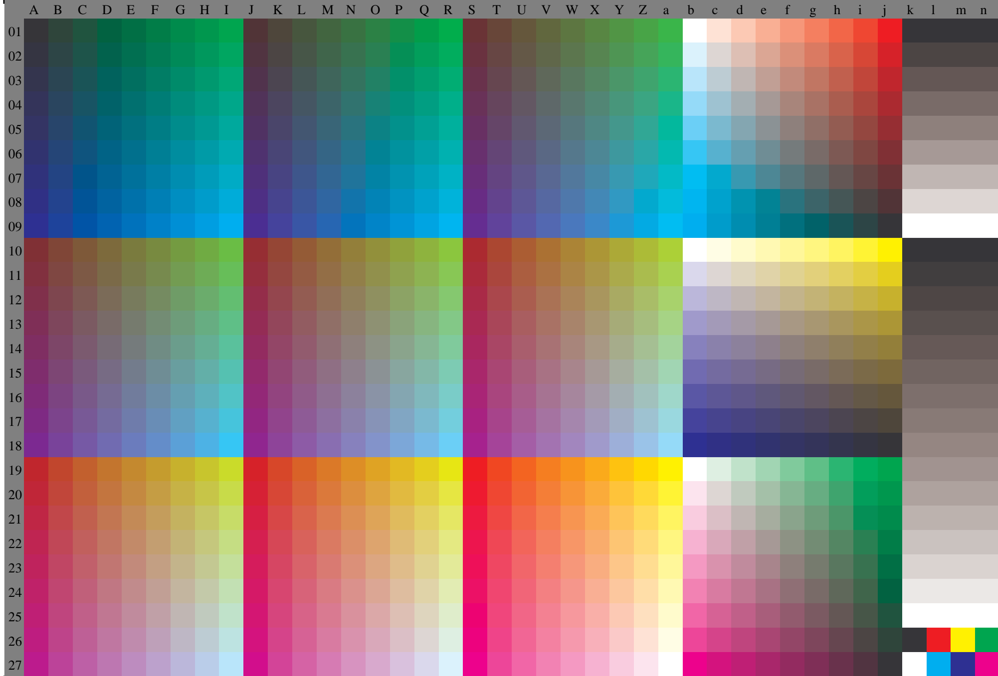
Fig. 80-7n, 6/11, Prüfvorlage G mit 40x27=1080 Farben; digital gleichabständige 9 oder 16stufige Farbreihen; Farbdaten in Spalte (A-n): cmY0 (A_n), colorm = 0, separation = F
