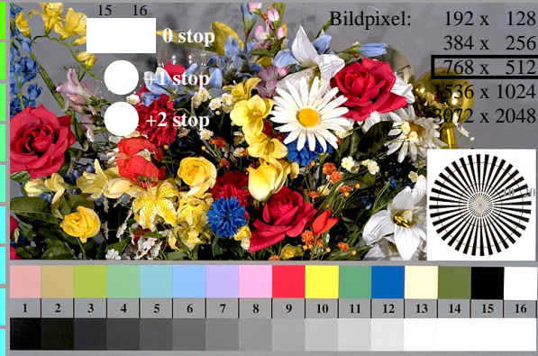
fgn20-7N, Bild B1-130-0: Blumenmotiv, 14 CIE-Prüffarben und 2+16 Graustufen (nI); PS-Operatoren settransfer, 3 colorimage
