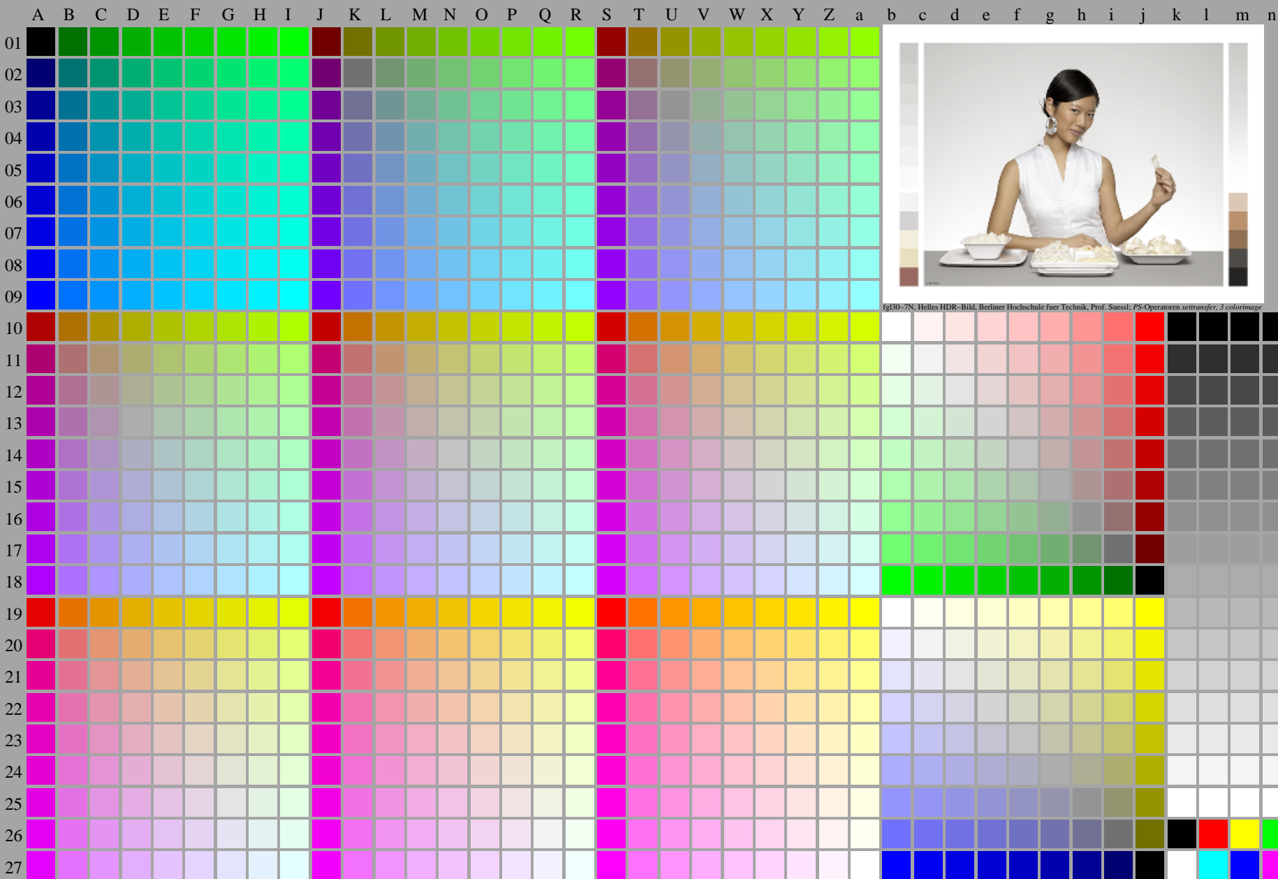
fgl30-7N, Seite 1/16, Prüfvorlage 2G mit 40x27=1080 Farben; digital gleichabständige 9 oder 16stufige Farbreihen; Farbdaten in Spalte (A-n): rgb^*_{d} (A_n), colorm = 1, xchart = 5, pchart = 0
