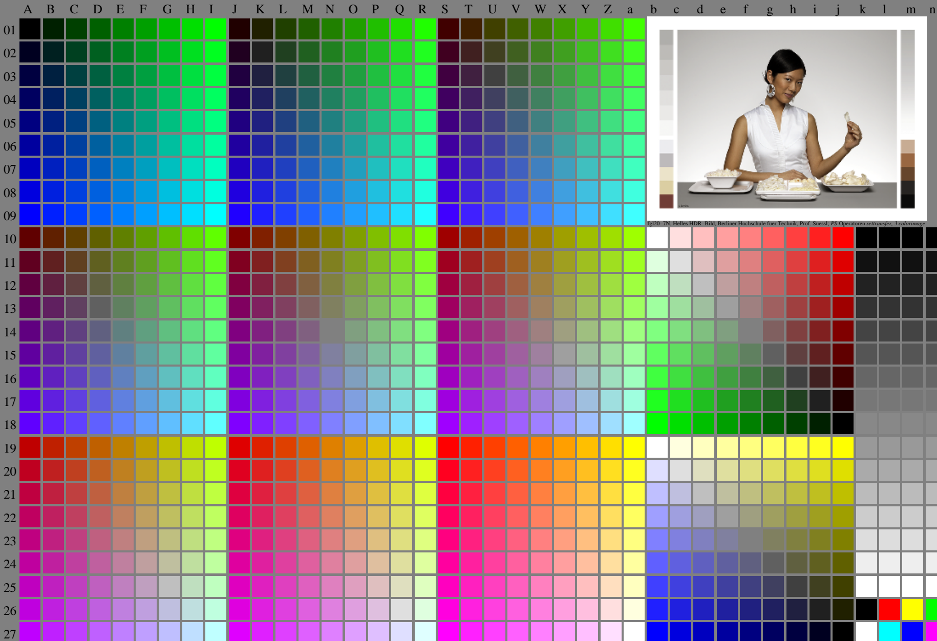
fgl2-7N, Seite 1/16, Prüfvorlage 2G mit 40x27=1080 Farben; digital gleichabständige 9 oder 16stufige Farbreihen; Farbdaten in Spalte (A-n): rgb^*_d(A_n) , colorm = 1 , xchart = 0 , pchart = 0
