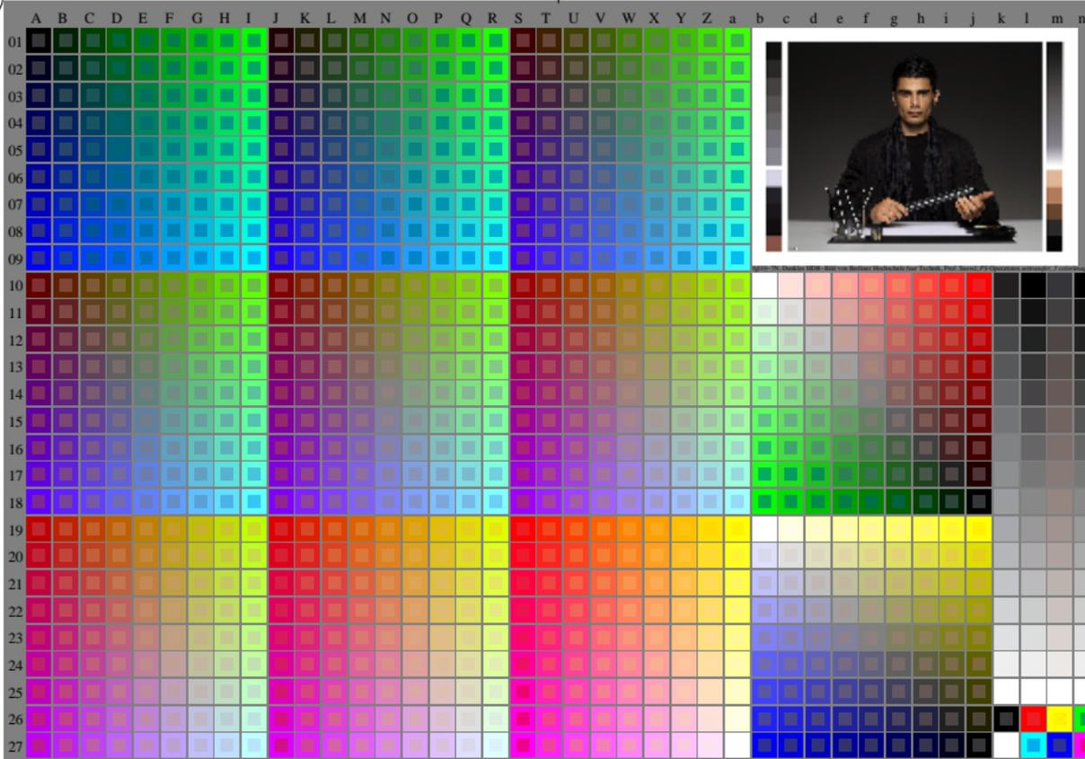
fgl10-7N, Seite 1/16, Prüfvorlage 2G mit 40x27=1080 Farben; digital gleichabständige 9 oder 16stufige Farbzeilen; Farbdaten in Spalte (A-n): rgb + cmy0 (A\_j + k26\_n27), 000n (k), w (l), nnn0 (m), www (n), color = 0, xchart = 0, pchart = 0
