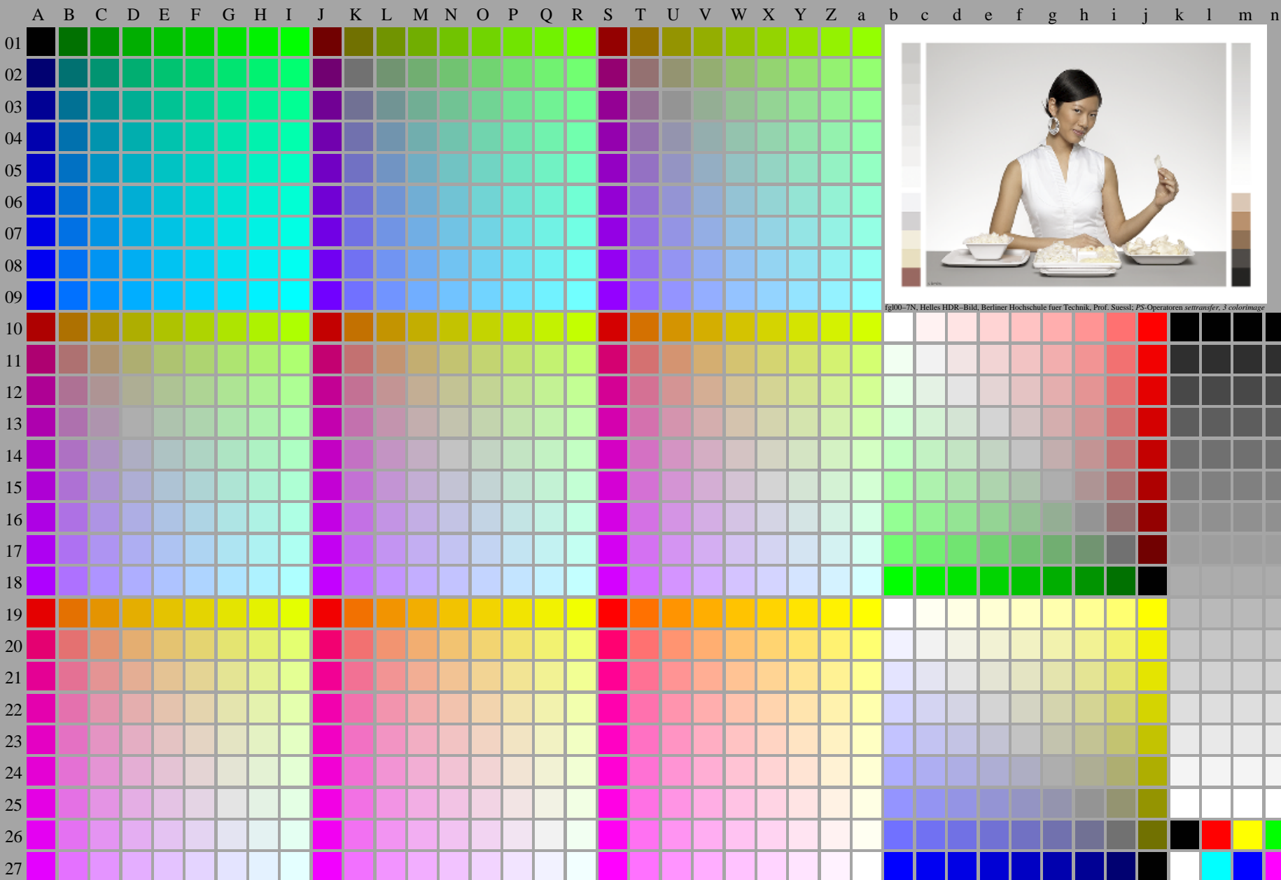
fgl00-7N, Seite 1/16, Prüfvorlage 2G mit 40x27=1080 Farben; digital gleichabständige 9 oder 16stufige Farbreihen; Farbdaten in Spalte (A-n): rgb^*_d(A_n) , colorm = 1, xchart = 5, pchart = 0
