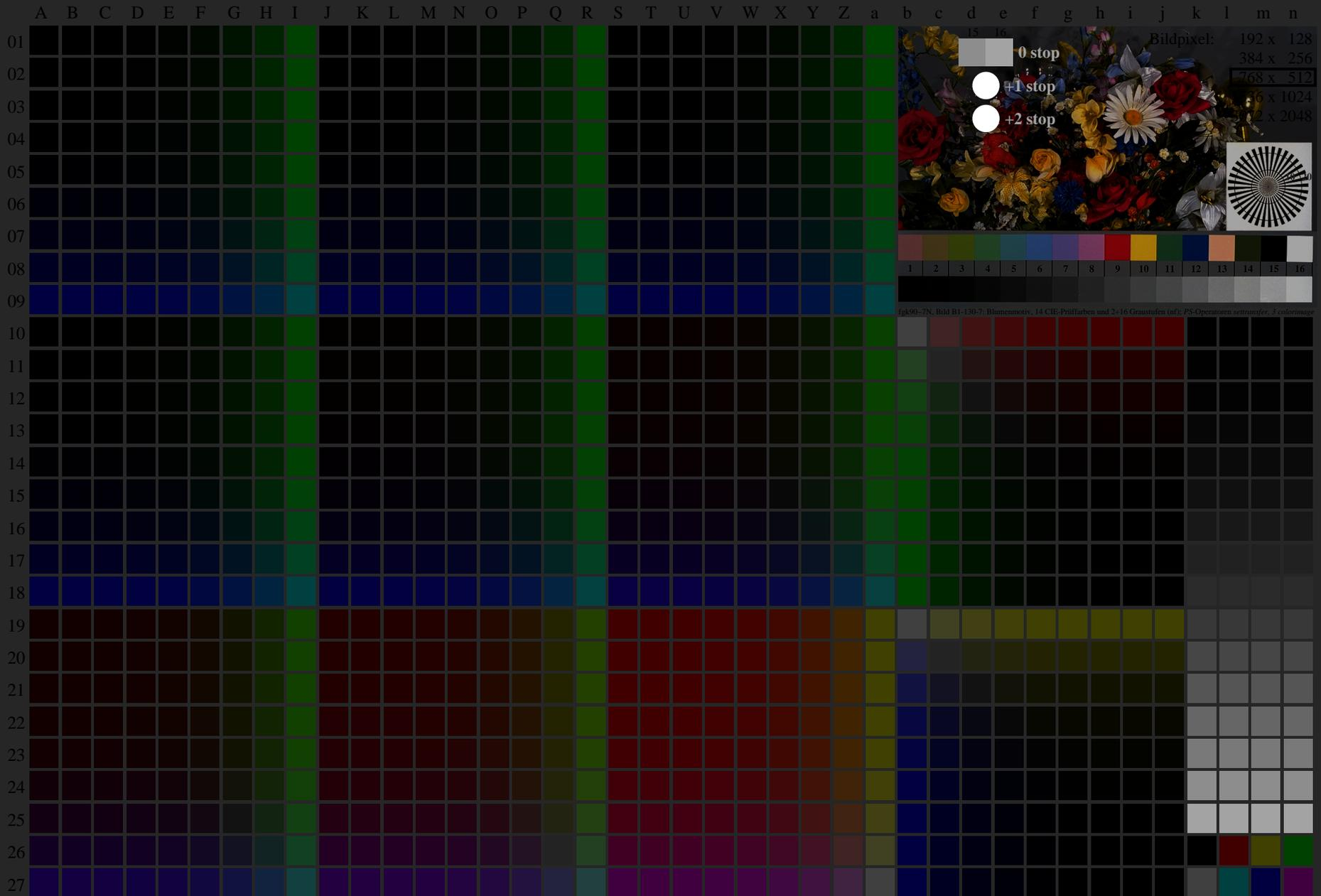
fgk90-7N, Seite 1/16, Prüfvorlage 2G mit 40x27=1080 Farben; digital gleichabständige 9 oder 16stufige Farbreihen; Farbdaten in Spalte (A-n): rgb\*(A\_n), colormap = 1, xchart = 56, pchart = 0
