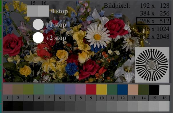
fgk90-7N, Bild B1-130-1: Blumenmotiv, 14 CIE-Prüffarben und 2+16 Graustufen (n!); PS-Operatoren settransfer, 3 colorimage
