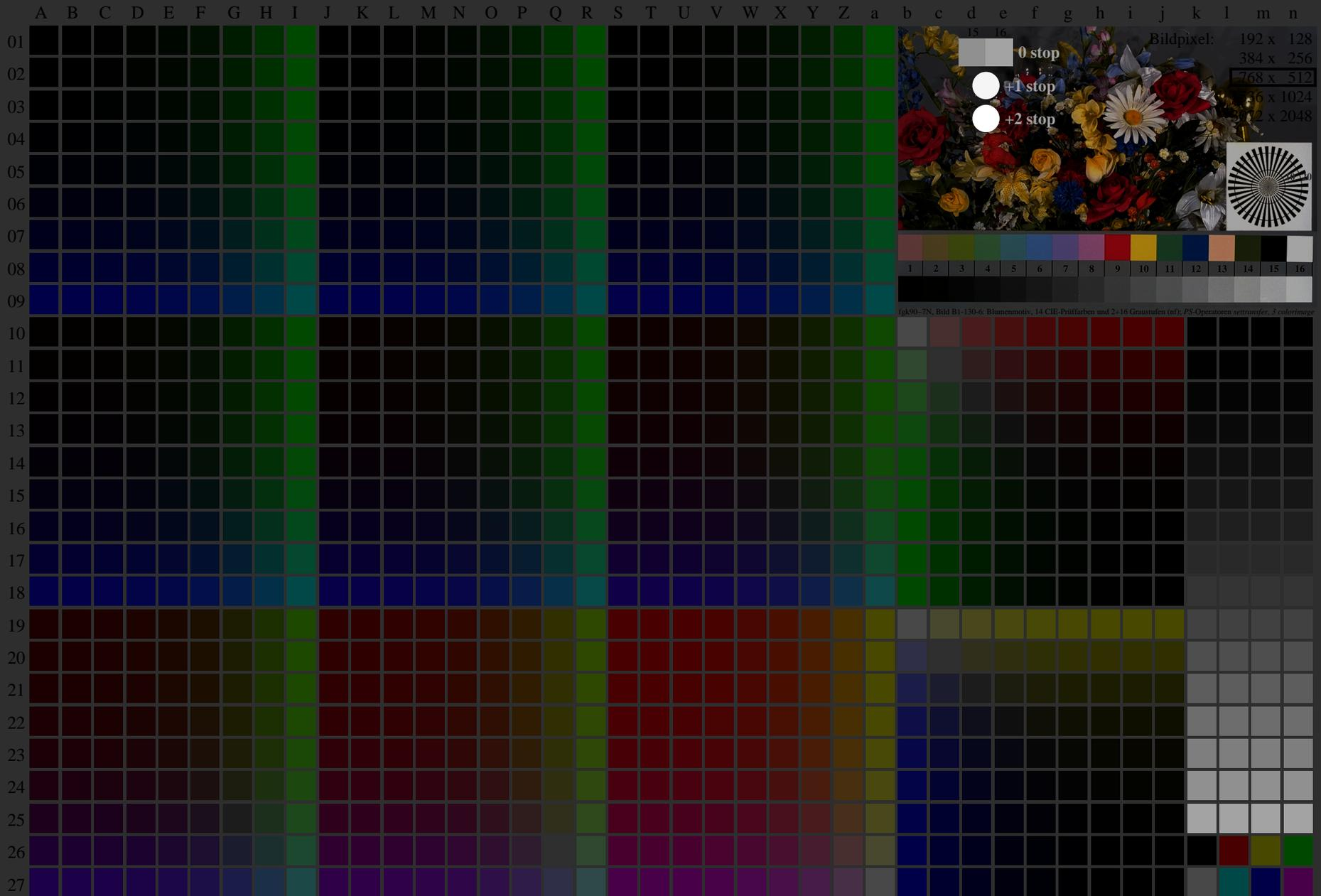
fgk90-7N, Seite 1/16, Prüfvorlage 2G mit 40x27=1080 Farben; digital gleichabständige 9 oder 16stufige Farbreihen; Farbdaten in Spalte (A-n): rgb\*(A\_n), colorm = 1, xchart = 48, pchart = 0
