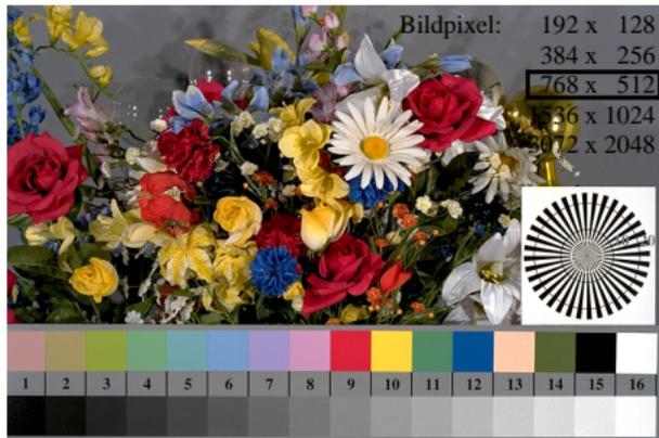
egb81-3n, Bild D1: Blumenmotiv, 14 CIE-Prüffarben und 16 Graustufen (nf); PS-Operatoren *settransfer*, 3 *colorimage*
