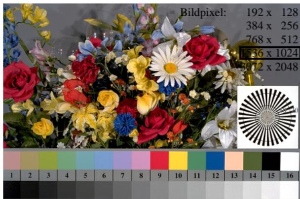
egb81-7n, Bild D1: Blumenmotiv, 14 CIE-Prüffarben und 16 Graustufen (nf); PS-Operatoren *settransfer*, 3 *colorimage*
