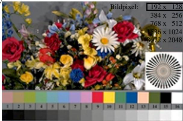
egb80-3n, Bild D1: Blumenmotiv, 14 CIE-Prüffarben und 16 Graustufen (nf); PS-Operatoren *settransfer*, 3 *colorimage*
