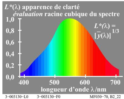
Fig. 21 : sensibilité lumineuse spectrale et apparence de clarté
