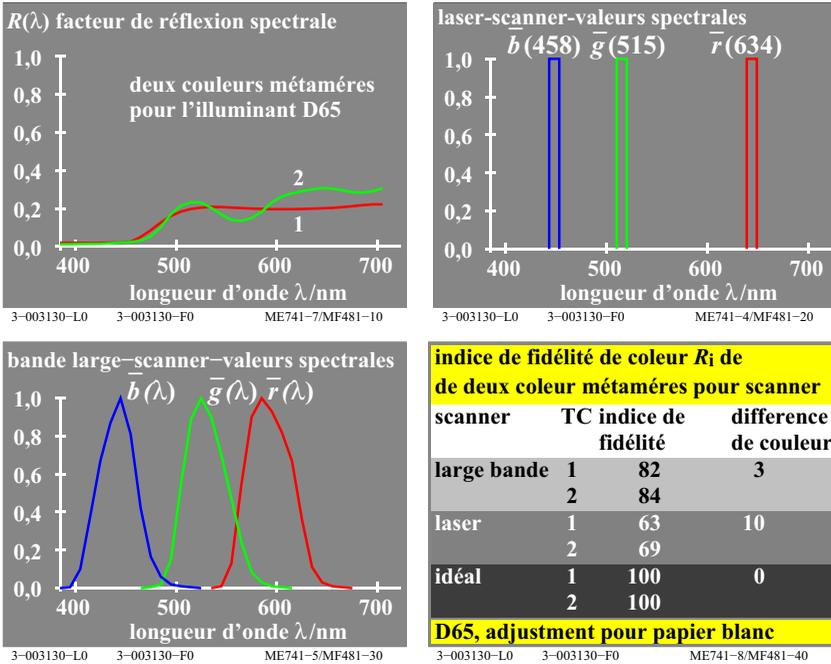
**Fig. 44 : deux couleurs-tests métamères, signaux du scanner et rendu de couleurs**
