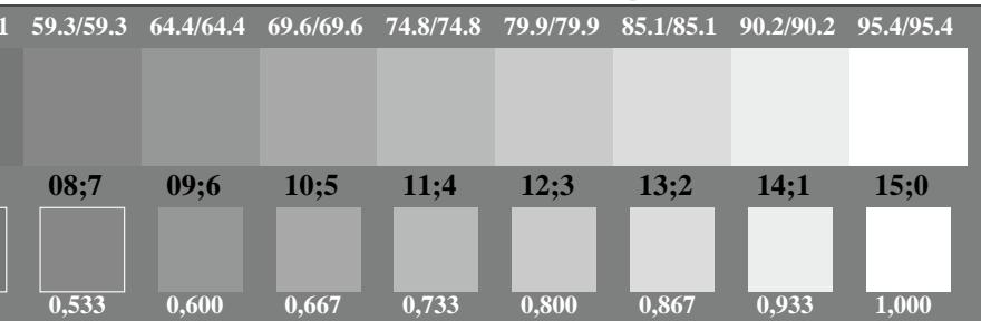
TG700-7, Bild C3Wdd: Element C: 16 visuell gleichabständige L\*-Graustufen; PS-Operator: *rgb/cm/y0*
