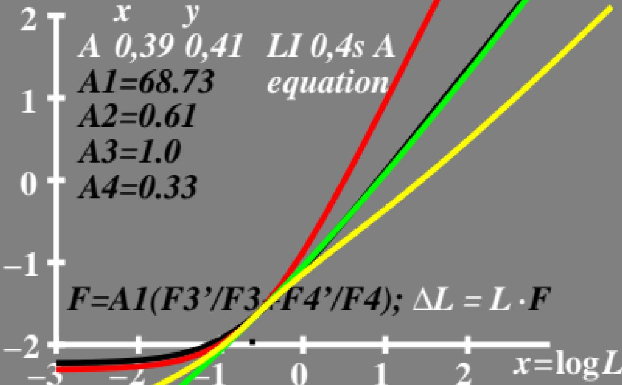
$\log \Delta L$  Leuchtdichte-Differenzschwelle;  $\Delta L = L \cdot F$  •  $L_{ge} = 1 \text{ cd/m}^2$
