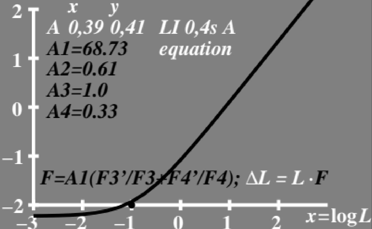
$\log \Delta L$  Leuchtdichte-Differenzschwelle;  $\Delta L = L \cdot F$  •  $L_g = 1 \text{ cd/m}^2$
