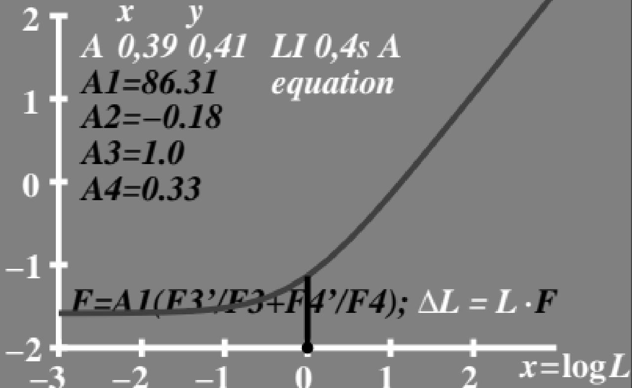
$\log \Delta L$  Leuchtdichte-Differenzschwelle;  $\Delta L = L \cdot F$  •  $L_g = 10 \text{ cd/m}^2$
