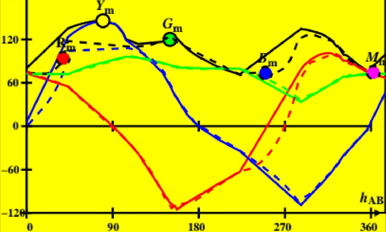
**CIE-Daten für antichromatische Optimalfarben von maximalem Buntwert für P00,  $Y_{m,10}=100$ ,  $Y_m=520$  770,  $B_m=380$  520**
