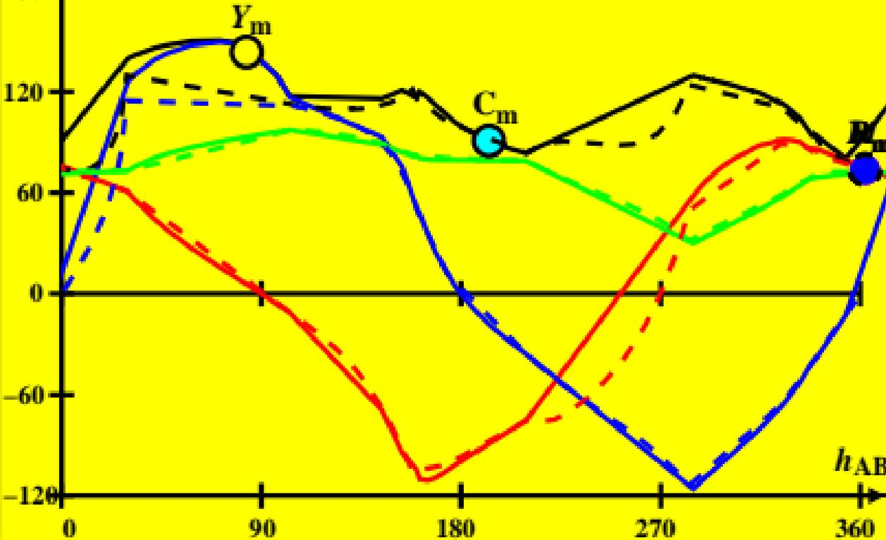
**CIE-Daten für antichromatische Optimalfarben von maximalem Buntwert für Q00,  $Y_{w,10}=100$ ,  $Y_m=520\ 770$ ,  $B_m=380\ 520$**
