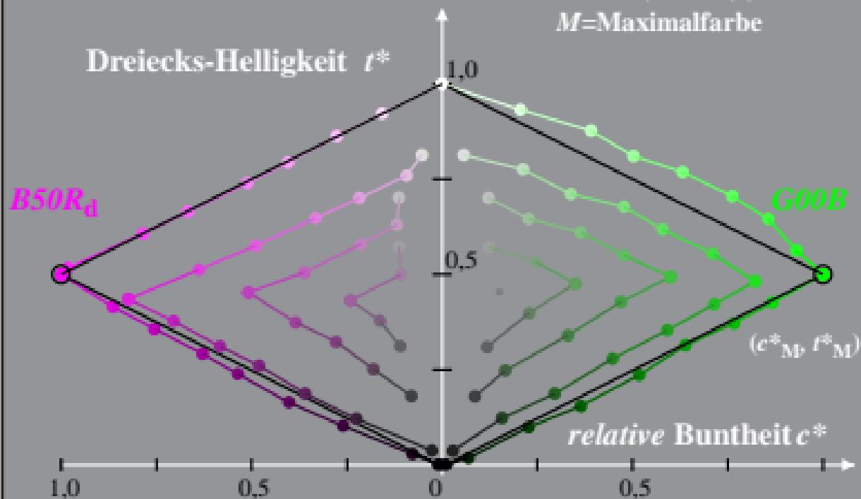
Beziehung adaptiertes (a) CIELAB ( $C_{ab,a}^*$ ,  $L^*$ ) und relatives CIELAB ( $c^*$ ,  $t^*$ )
