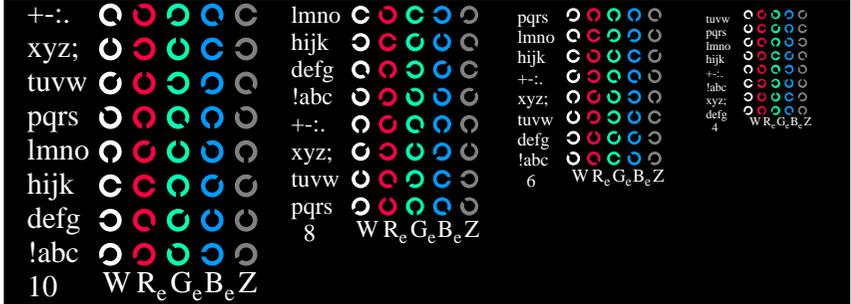
OG661-3, Bild D5N-130-0: Schrift und Landoltringe W; Re; Ge; Be; Z; PS-Operator ->rgb<sub>e</sub> setrgbcolor
