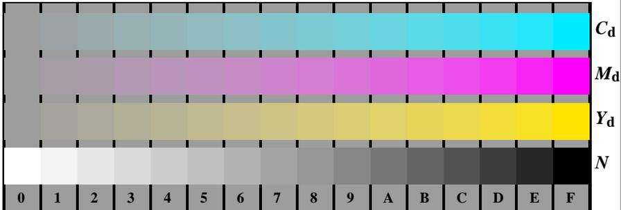
OG651-1, Bild B4Z-Z-134-0: 16 gleichabständige Stufen Z-C\_d; Z-M\_d; Z-J\_d; W-N; PS: ->rgb\_d setrgbcolor
