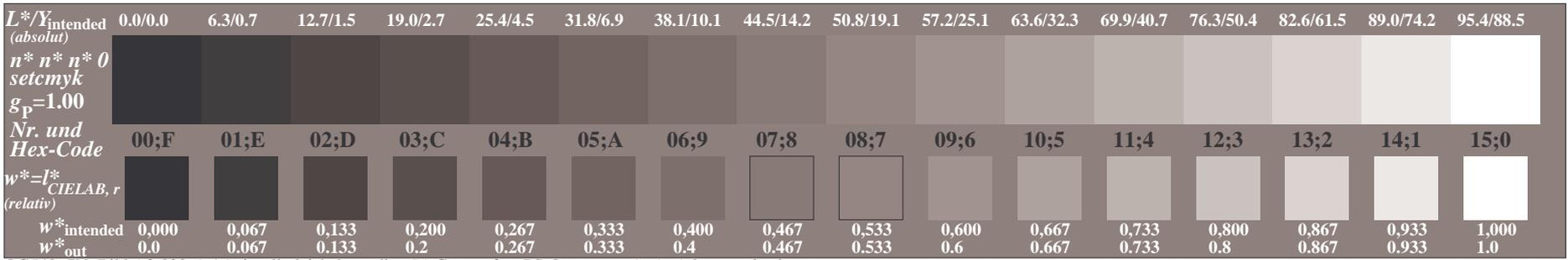
OG540-7N, Bild A3-020-6: 16 visuell gleichabständige  $L^*$ -Graustufen; PS-Operator:  $n^* n^* n^* 0$  setcmykcolor
