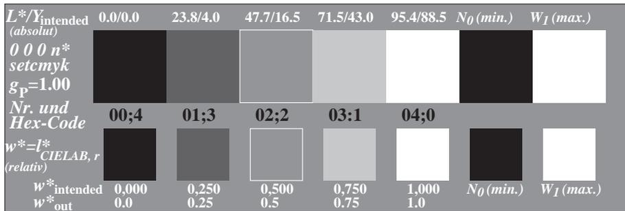
OG540-5N, Bild A2-000-0: 5 gleichabständige  $L^*$ -Graustufen+ $N_0$ + $W_1$ ; PS-Operator: 0 0 0 n\* setcmykcolor
