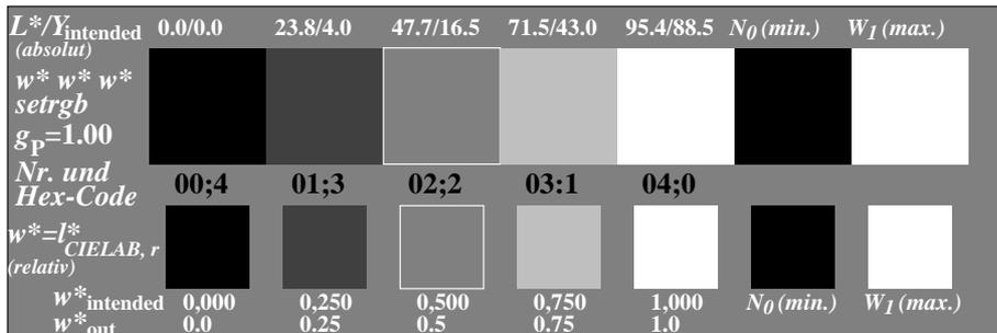
OG540-5N, Bild A2-030-9: 5 gleichabständige L\*-Graustufen+N0+W1; PS-Operator: w\* w\* w\* setrgbcolor
