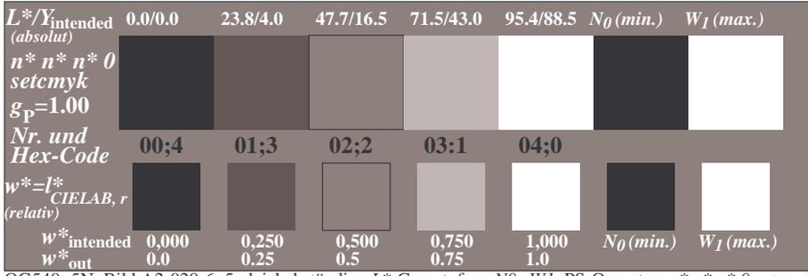
OG540-5N, Bild A2-020-6: 5 gleichabständige  $L^*$ -Graustufen+ $N_0$ + $W_1$ ; PS-Operator:  $n^* n^* n^* 0$  setcmykcolor
