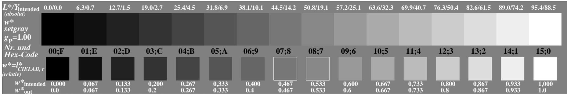
OG540-7N, Bild A3-010-3: 16 visuell gleichabständige  $L^*$ -Graustufen; PS-Operator: w\* setgray
