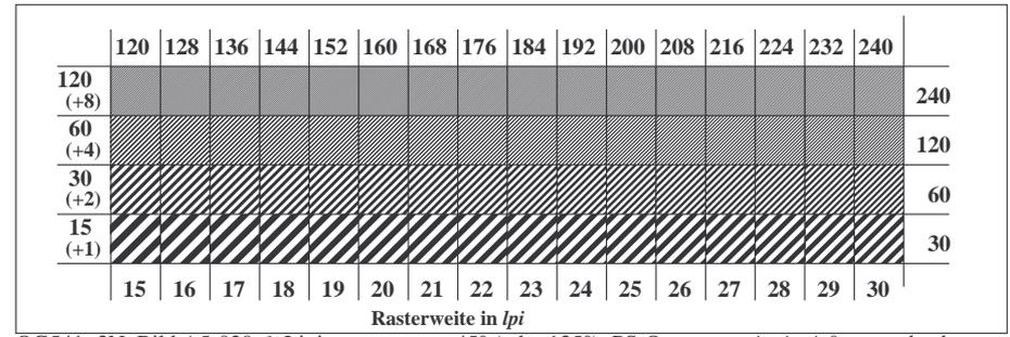
OG541-3N, Bild A5-020-6: Linienraster unter 45° (oder 135°); PS-Operator:  $n^* n^* n^* 0$  setcmykcolor
