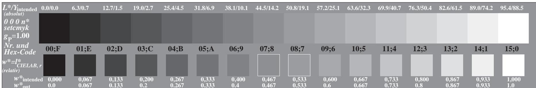
OG540-7N, Bild A3-000-0: 16 visuell gleichabständige  $L^*$ -Graustufen; PS-Operator: 0 0 0 n\* setcmykcolor
