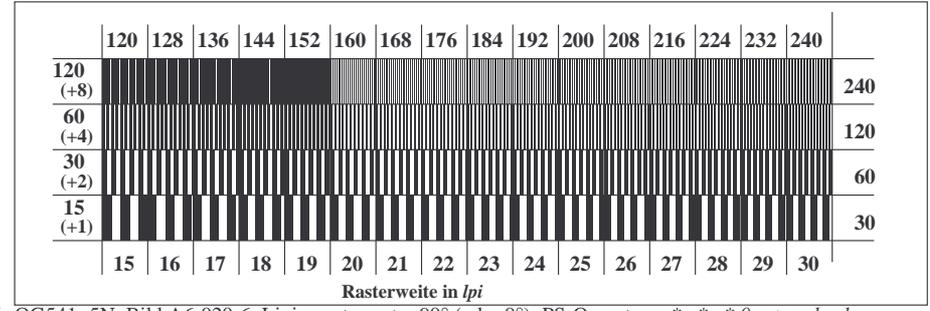
OG541-5N, Bild A6-020-6: Linienraster unter 90° (oder 0°); PS-Operator:  $n^* n^* n^* 0$  setcmykcolor
