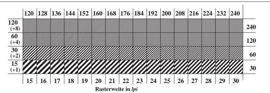
OG541-3N, Bild A5-000-0: Linienraster unter 45° (oder 135°); PS-Operator: 0 0 0 n\* setcmykcolor
