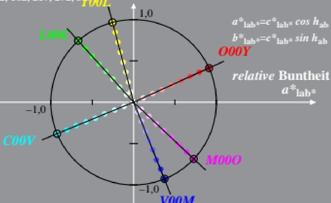
Beziehung adaptiertes (a) CIELAB ( $C^*_{ab,a}, L^*$ ) und relatives CIELAB ( $c^*, l^*$ )
