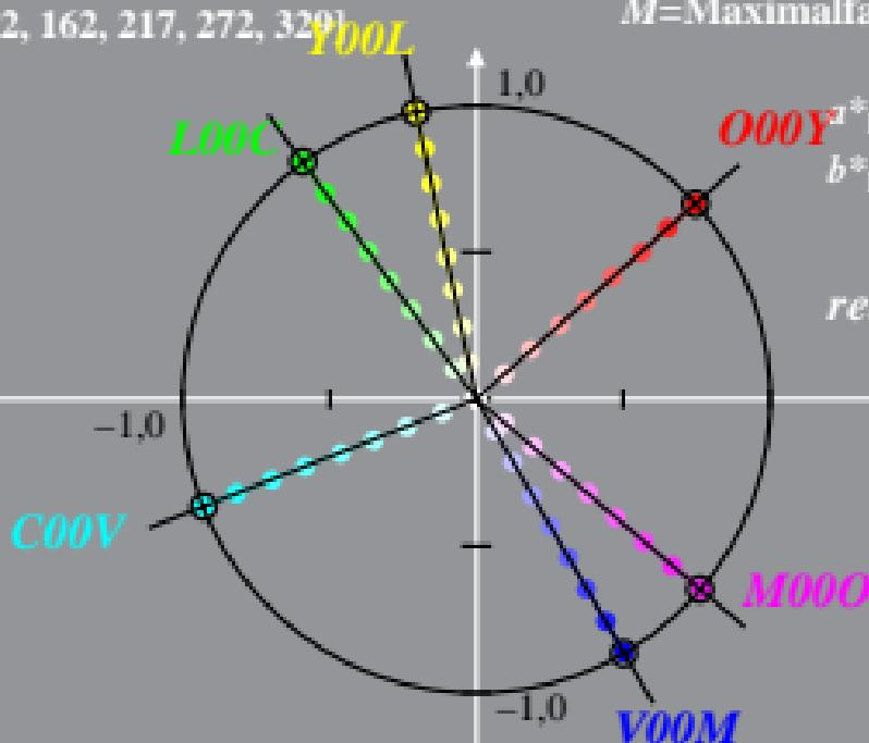
Beziehung adaptiertes (a) CIELAB ( $C^*_{ab,a}$ ,  $L^*$ ) und relatives CIELAB ( $c^*$ ,  $t^*$ )
