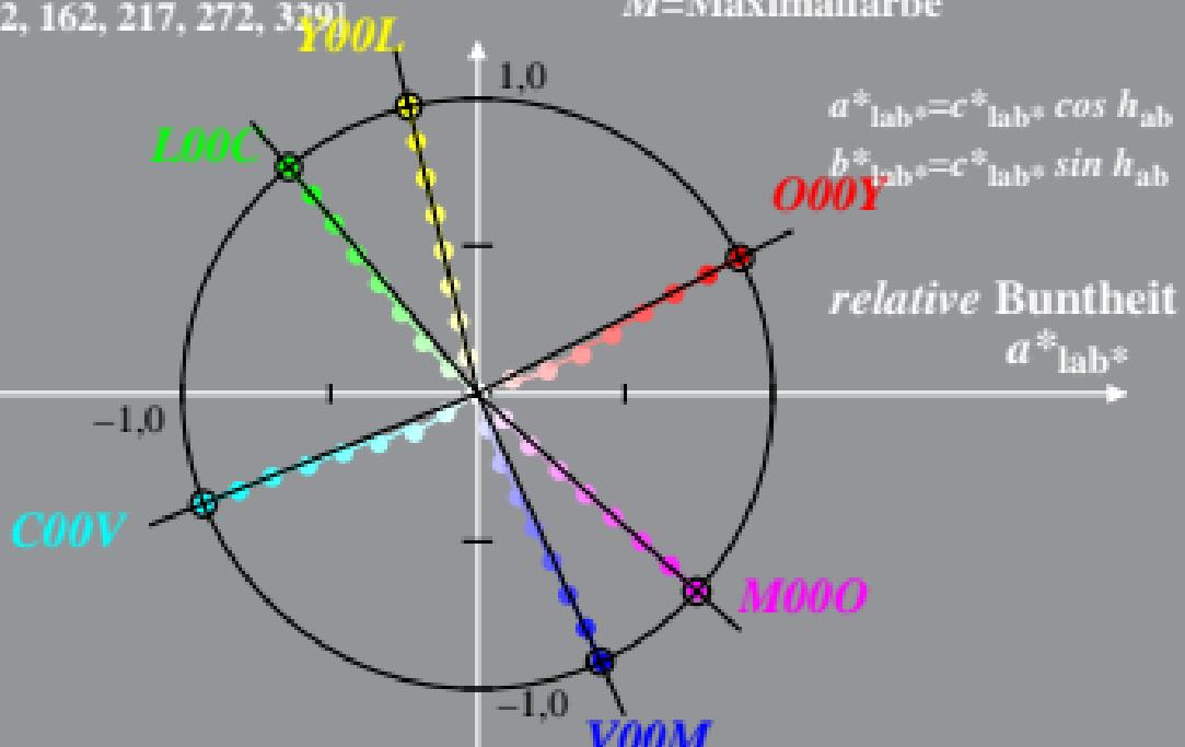
Beziehung adaptiertes (a) CIELAB ( $C^*_{ab,a}, L^*$ ) und relatives CIELAB ( $c^*, t^*$ )
