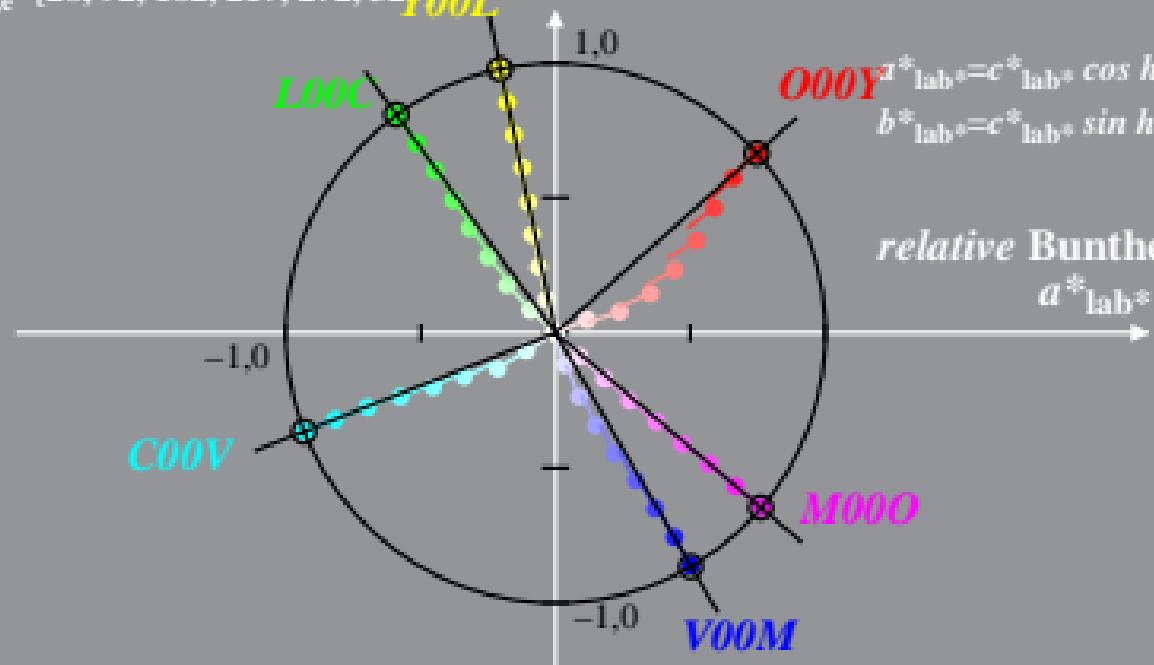
Beziehung adaptiertes (a) CIELAB ( $C^*_{ab,a}, L^*$ ) und relatives CIELAB ( $c^*, l^*$ )
