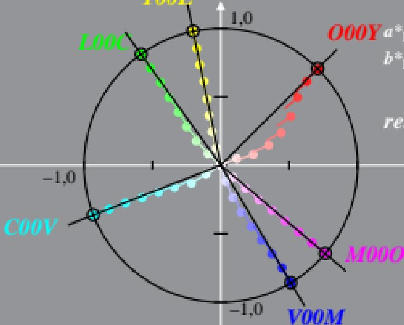
Beziehung adaptiertes (a) CIELAB ( $C^*_{ab,a}, L^*$ ) und relatives CIELAB ( $c^*, l^*$ )
