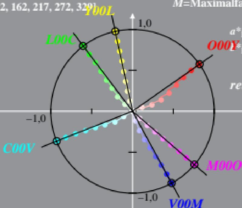
Beziehung adaptiertes (a) CIELAB ( $C^*_{ab,a}, L^*$ ) und relatives CIELAB ( $c^*, l^*$ )
