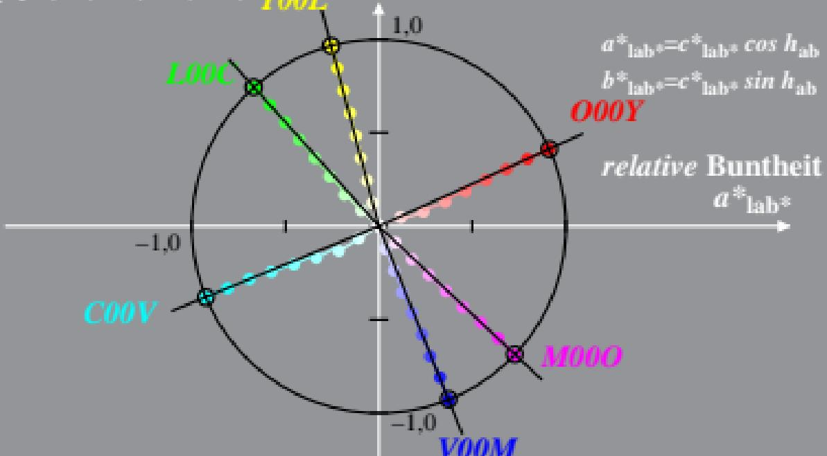
Beziehung adaptiertes (a) CIELAB ( $C^*_{ab,a}, L^*$ ) und relatives CIELAB ( $c^*, l^*$ )
