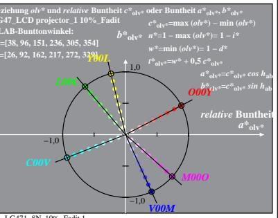
% LG47-7N, Prüfvorlage mit 1080 Norm-Farben; digital gleichabständige 9stufige Bunton- und unbunte Reihen;; Leuchtstärkefaktor gemessen:  $Yn=Yw=89$ , Seite 12/16; Display-Typ: LCD projector\_100901\_1
