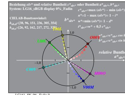
% LG16-7N, Prüfvorlage mit 1080 Norm-Farben; digital gleichabständige 9stufige Buntton- und unbunte Reihen; Leuchtdichtefaktor gemessen:  $Y_n$  und normiert:  $Y_n = Y_w = 89$ ; für Norm-sRGB-Display, Seite 1/2; Display-Typ: sRGB\_IEC\_61966\_2\_1
