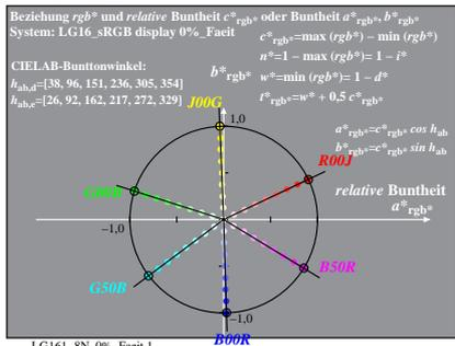
% LG16-7N, Prüfvorlage mit 1080 Norm-Farben; digital gleichabständige 9stufige Buntton- und unbunte Reihen; Leuchtdichtefaktor gemessen:  $Y_n$  und normiert:  $Y_n = Y_w = 89$ ; für Norm-sRGB-Display, Seite 2/2; Display-Typ: sRGB\_IEC\_61966\_2\_1
