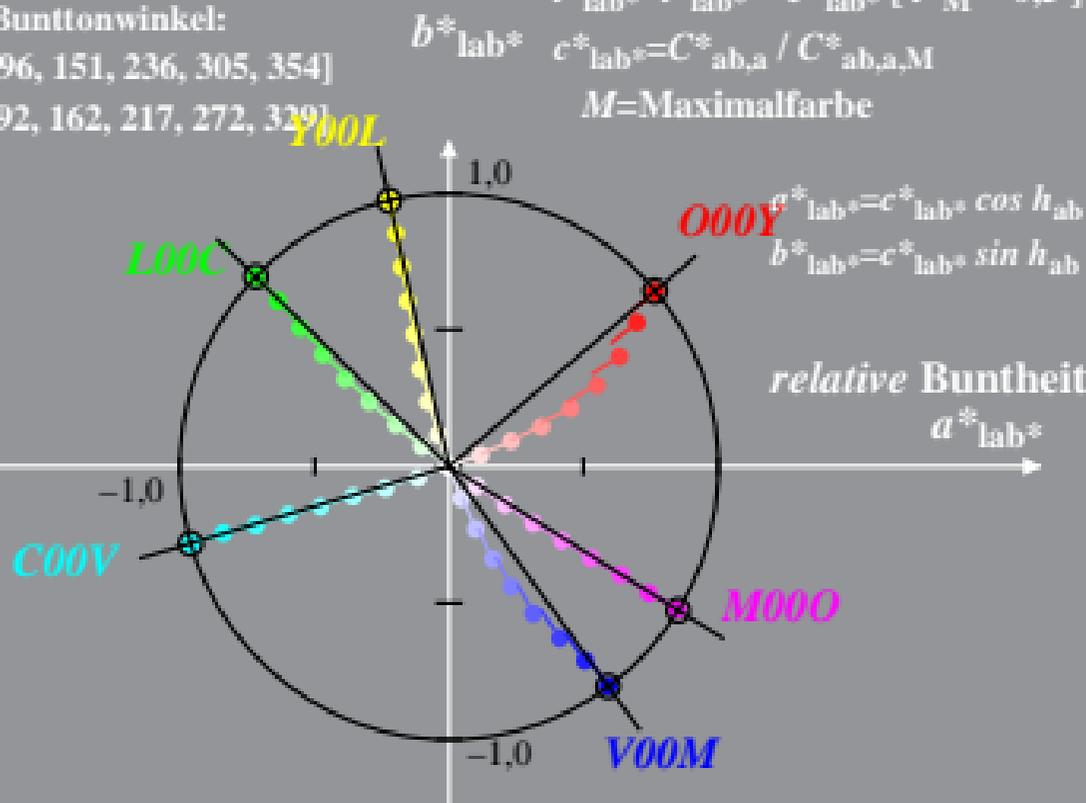
Beziehung adaptiertes (a) CIELAB ( $C^*_{ab,a}$ ,  $L^*$ ) und relative CIELAB ( $c^*$ ,  $t^*$ )
