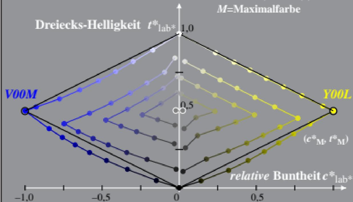
Beziehung adaptiertes (a) CIELAB ( $C^*_{ab,a}$ ,  $L^*$ ) und relatives CIELAB ( $c^*$ ,  $l^*$ ) System: JG09\_LECD display 2,5%\_G0
