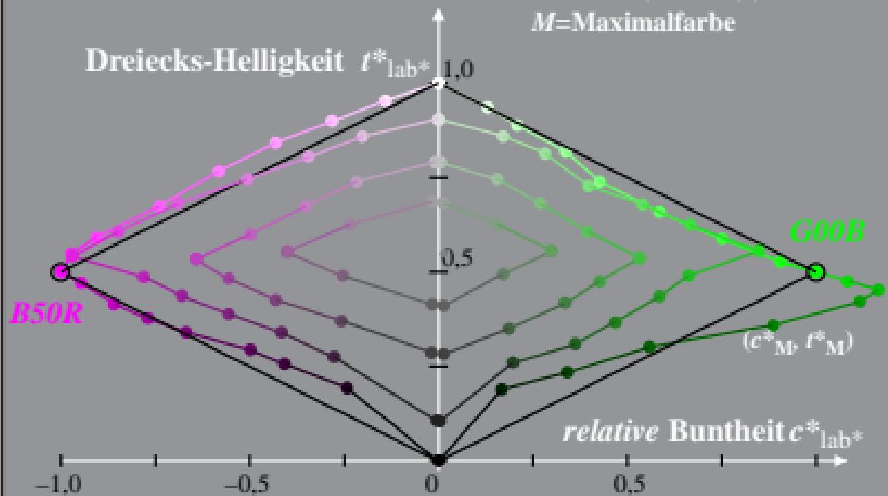
Beziehung adaptiertes (a) CIELAB ( $C^*_{ab,a}$ ,  $L^*$ ) und relatives CIELAB ( $c^*$ ,  $l^*$ ) System: HG92\_HRS16\_96\_D65\_00%\_01
