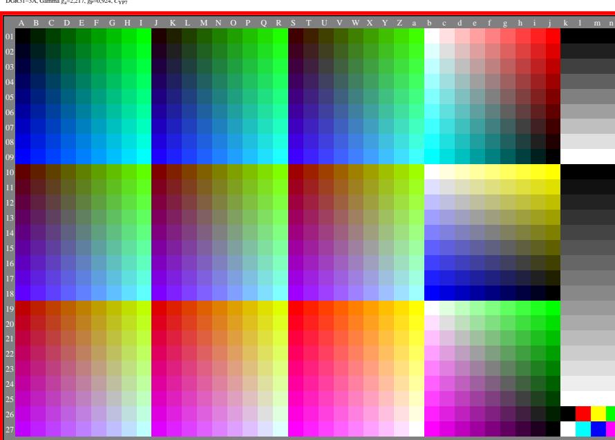
TUB-Prüfvorlage DGR3; Prüfung gleicher Stufenerkennbarkeit, Gamma  $gp=1.00$ , Cyp8
