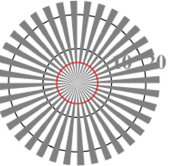
Bild D2: Radialgitter (Siemenssterne)  $W-O$ ,  $W-L$ ,  $W-V$ ,  $W-N$  und  $W-Z$
