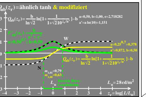
TUB-Prüfvorlage DGG8; Modell für Erregungsfunktionen  $Q_{ab}(x_r)$  und Ableitungen  $Q'_{ab}(x_r)$  logarithmische Erregungsfunktionen  $Q_{ab}(z_r)$  und Ableitungen mit  $e^{x_r/a}$  und  $10^{x_r/a}$ ;  $a^n=a^0$  Ausgabe:  $rgb$
