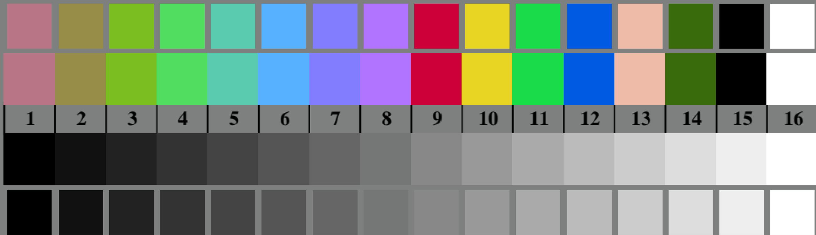
DGE10-7, Bild D3: 14 CIE-Prüffarben nach CIE 13.3 und 16 Graustufen
